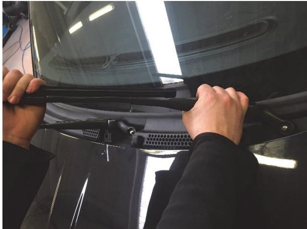
4. Rimuovete la protezione in plastica sotto i tergilustri: estraete le tre clips usando un cacciavite.
