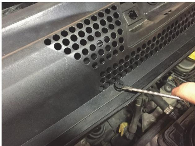
Rimuovete quindi l'intero pannello in plastica dopo aver disconnesso il tubo che porta l'acqua ai tergilavori e ruotando gentilmente il pannello verso l'alto in modo da sganciare le sei clips bianche posizionate sotto il parabrezza.
