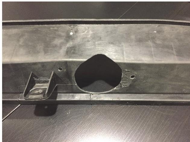
Ruotate il pannello di 180° e rimuovete l'aletta di plastica fresandola, come mostrato sotto.
