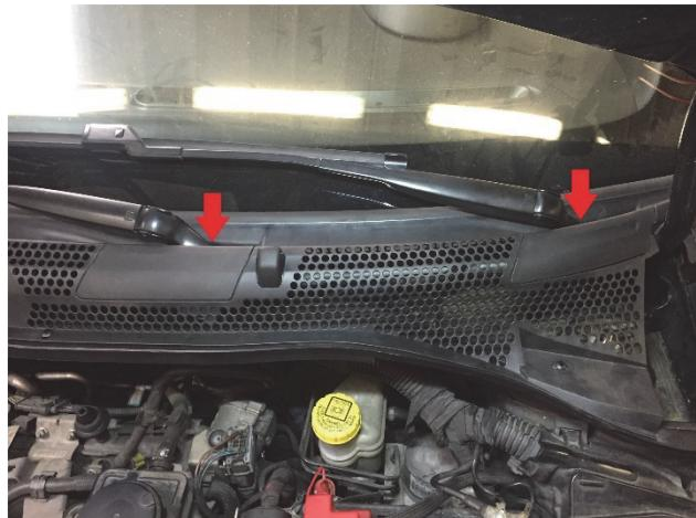
2. Utilizzando un piccolo cacciavite, sfilate i due tappi che nascondono le viti di fissaggio dei tergicristalli.
