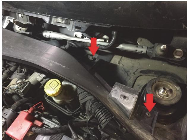
Rimuovete i dadi in plastica da 10 mm che fissano il pannello ad entrambe le estremità.
