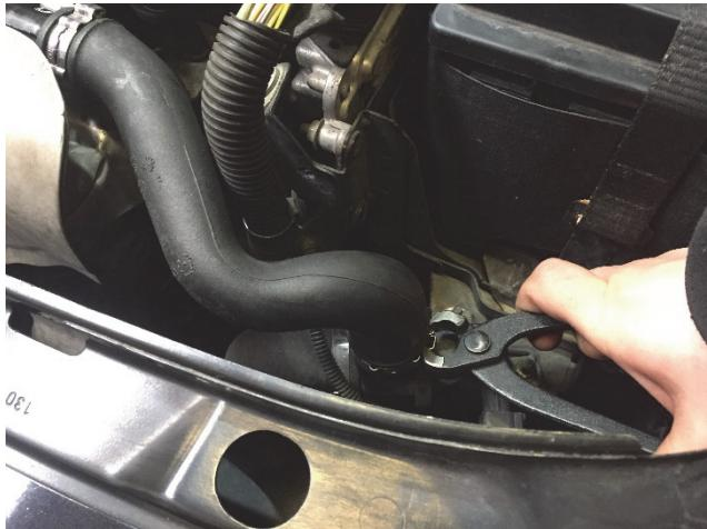
3. Rimuovete la piccola clip posizionata dietro la presa di aspirazione e svitate la vite che sorregge l'airbox.
